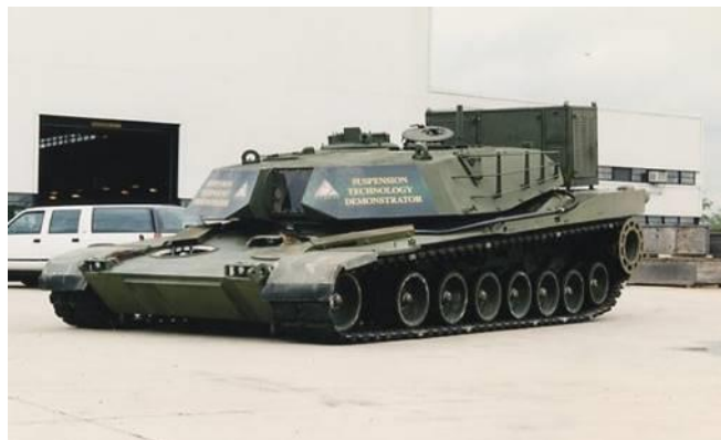
2.2.2. ábra: Hidropneumatikus felfüggesztéssel rendelkező Abrams prototípus
